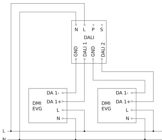
Schema elettrico Master-Master collegamento in rete
